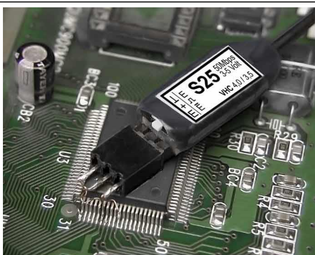
Bild 2 Im Prüfling eingebauter Sensor S25
